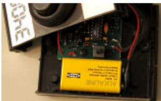
Achten Sie beim Schließen des Gehäuses auf evtl. eingeklemmte Kabel, insbesondere der Taster darf nicht durch solche verdeckt werden. Die LED des oberen Gehäuseteils zeigt zur Rückseite, an der sich im unteren Teil der '24one' Schalter und die Kabelöffnung befinden. (Bitte Sie ggf. einen technisch begabten Bekannten um Hilfe.)
