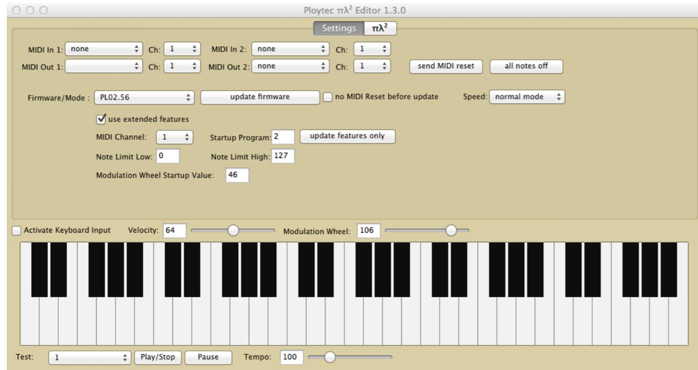
Übertragungsgeschwindigkeit in drei Stufen (fast mode: ca. 3s, normal mode: ca. 7s, save mode: ca. 30s) gewählt werden. Vermindern Sie die Geschwindigkeit (Speed) ggf., falls es zu Übertragungsproblemen kommen sollte.
